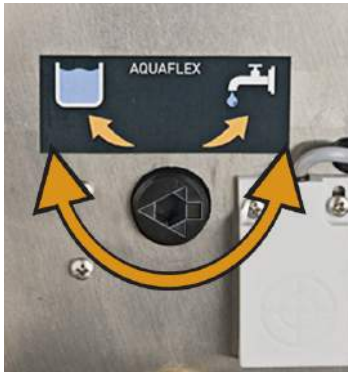
De stelschroef bevindt zich achter de drinkwatertank.
